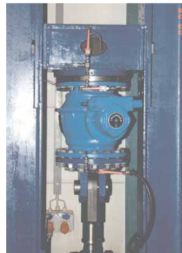
Шаровой кран «Баллостар»: испытание по EN 488
